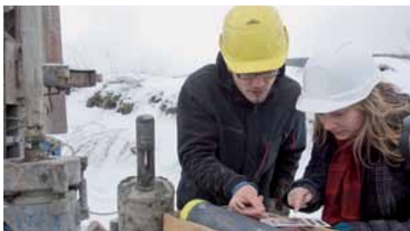
Farbbestimmung des Spülsandes am geöffneten PVC Liner Quelle | © TUBAF/Mario Köhler
