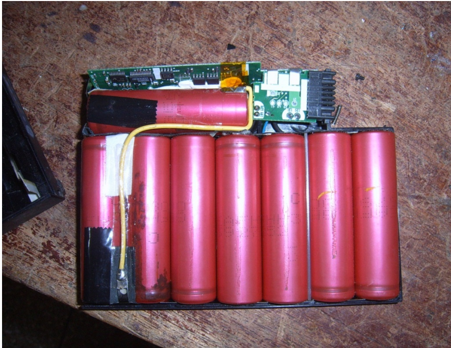
Abbildung 13 Batteriezellen des Akkublocks (eigene Aufnahme Öko-Institut)
