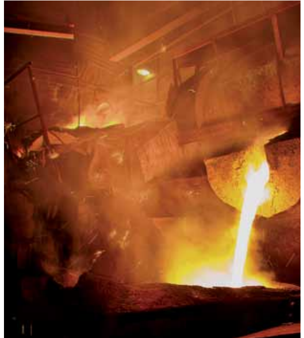
Abstich von Gusseisenschmelzen, für die zur Entschwefelung Magnesium benötigt wird
