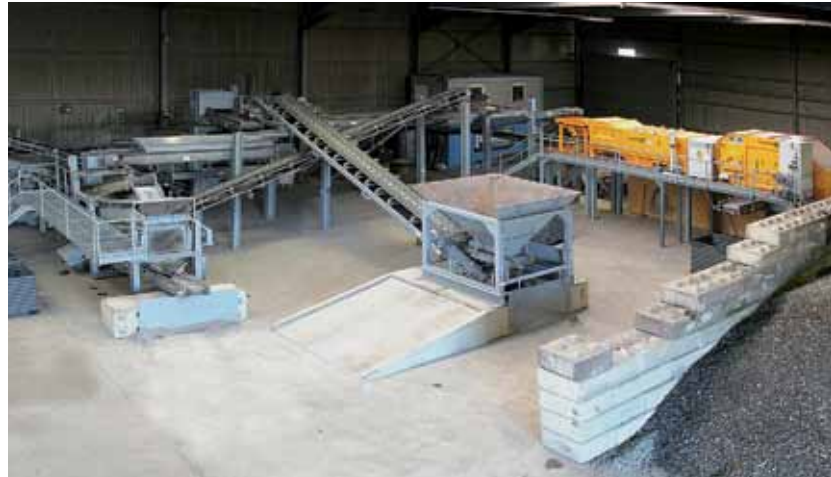
In der VeMRec-Versuchsanlage werden NE-Metalle aus Müllverbrennungsaschen weiter aufbereitet. Quelle | © MAV GmbH
